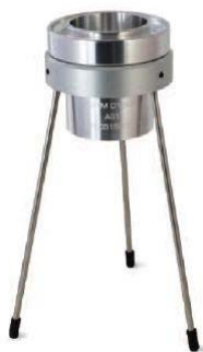
Slika 4.5: Prikaz stojala s pretočno skodelico (vir: Rhopoint instruments).
