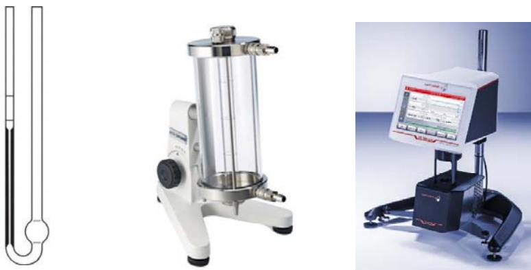
Slika 4.4: Primer viskozimetra s kapilaro (Ostwaldov viskozimeter, levo), primer viskozimetra s padajočo kroglico (Höpplerjev viskozimeter, sredina) in primer rotacijskega viskozimetra (desno).
